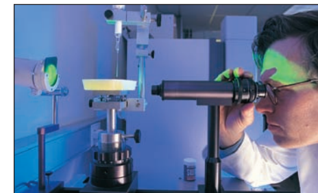
Messung des Kontaktwinkels zwischen Wasser und Wachs.
